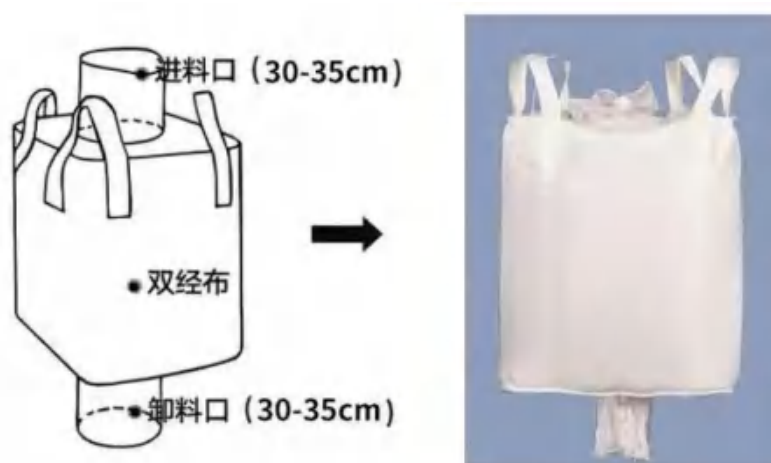
图 2.3-2 吨袋氧化镁投料示意图
