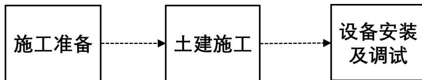
图 2-1 变电站工程施工流程图
