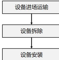
图3 变电站间隔改造工程施工工艺流程
