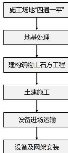
图2 变电站工程施工工艺流程
