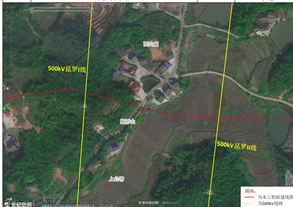
图 2-1 与 500kV 输电线路交叉跨越示意图
