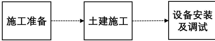
图 2-1 变电站工程施工流程图
