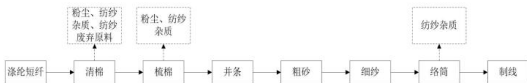
图 2-4 现有项目纺纱产品生产工艺流程图
