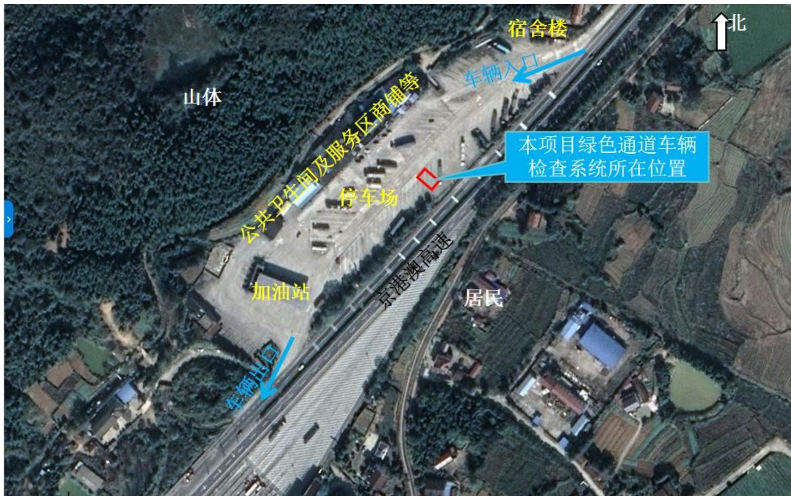
附图 2 羊楼司服务区平面布局及本项目绿色通道车辆检查系统所在位置
