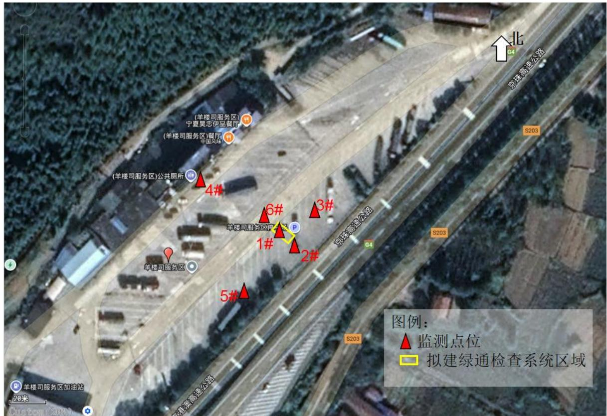
图 8-1 拟建绿通检查系统区域及周边环境监测布点示意图
