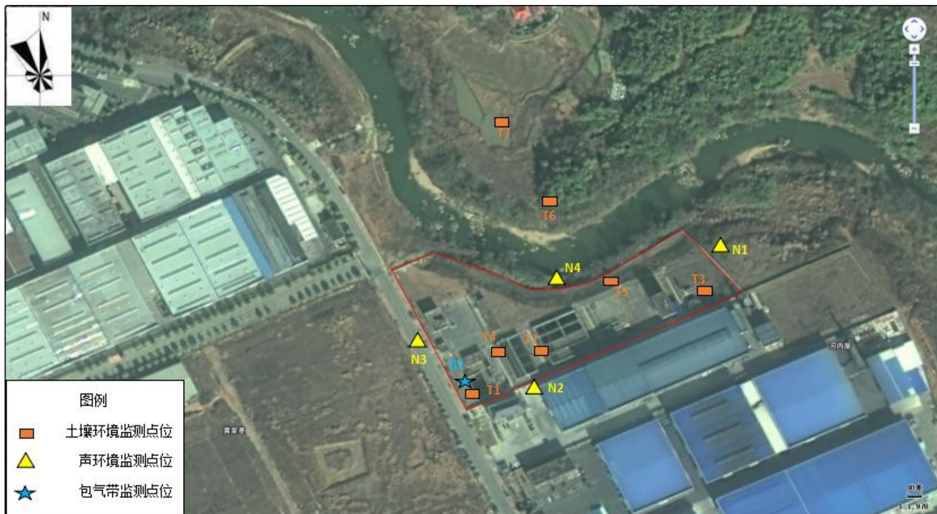
附图 5 项目土壤、噪声、包气带补充监测布点示意图
