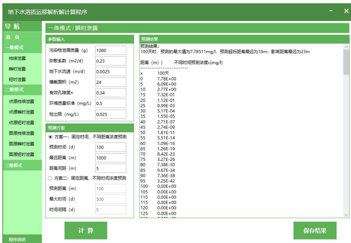
图 6.2-21 非正常状况下 NH 3 -N 在含水层中迁移 100d 污染晕的扩散范围图
