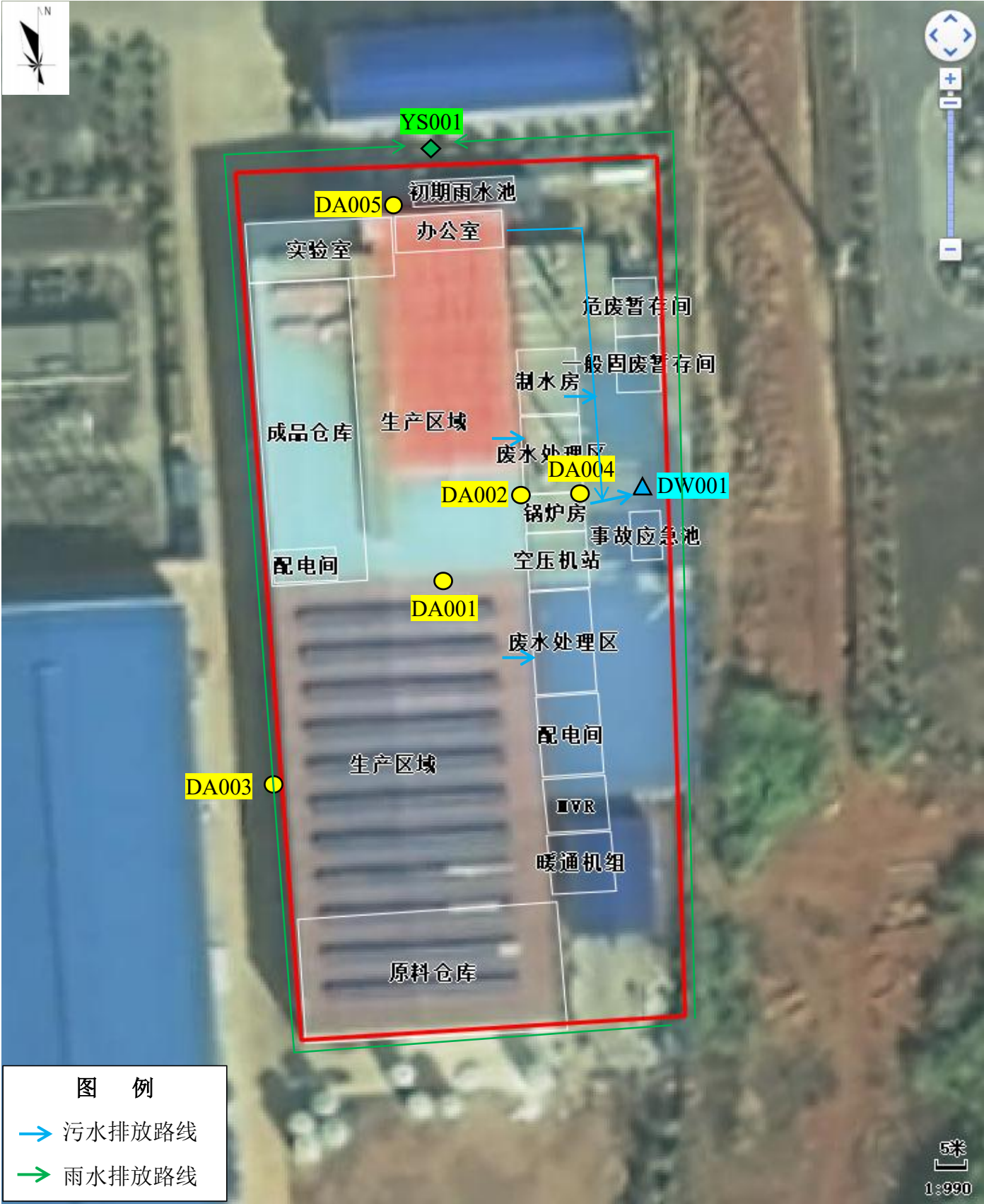
附图 9 项目雨污管线图
