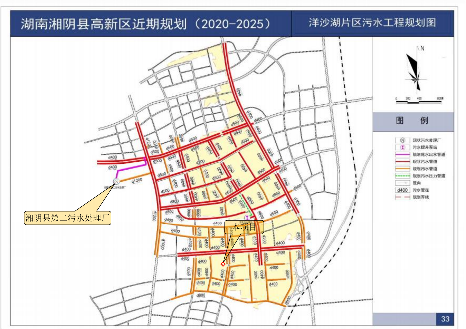
附图 4 洋沙湖片区污水工程规划图
