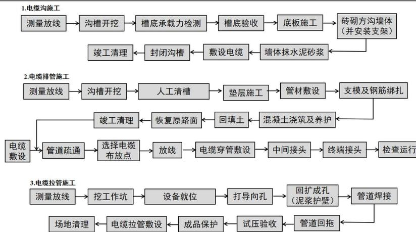
图 7 电缆线路施工工艺流程
