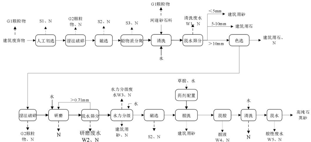
图 2-3 工艺流程及产污节点图
