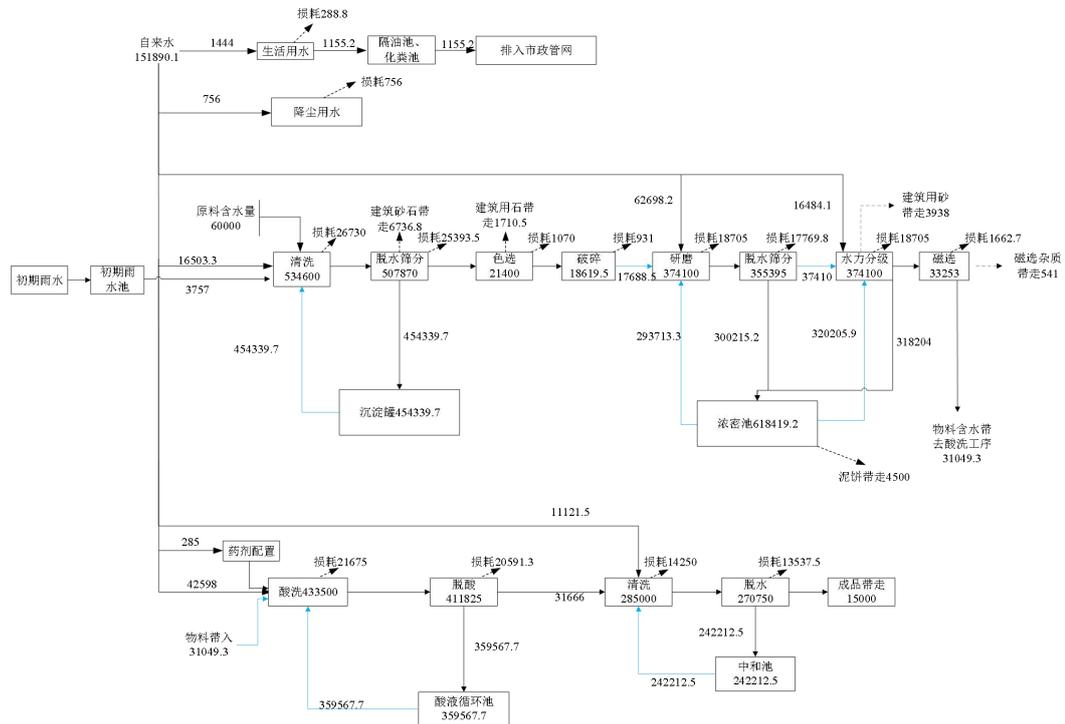
图 2-1 水平衡图（最大用水量，单位：m<sup>3</sup>/a）
