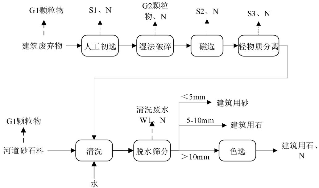
图 2-4 现有项目生产工艺流程图
