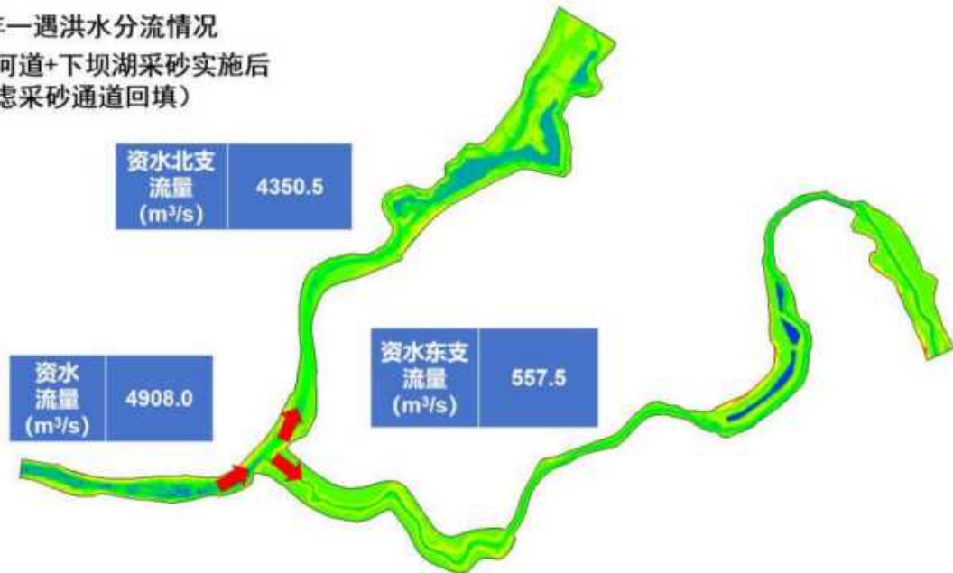
图 4.2-7 两年一遇洪水流量下现状河道+下坝湖采砂实施后毛角口分流情况 (考虑采砂通道回填)
