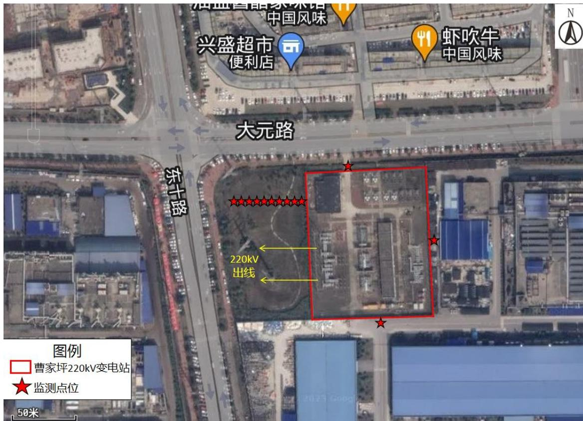
图10 曹家坪 220kV 变电站监测布点示意图
