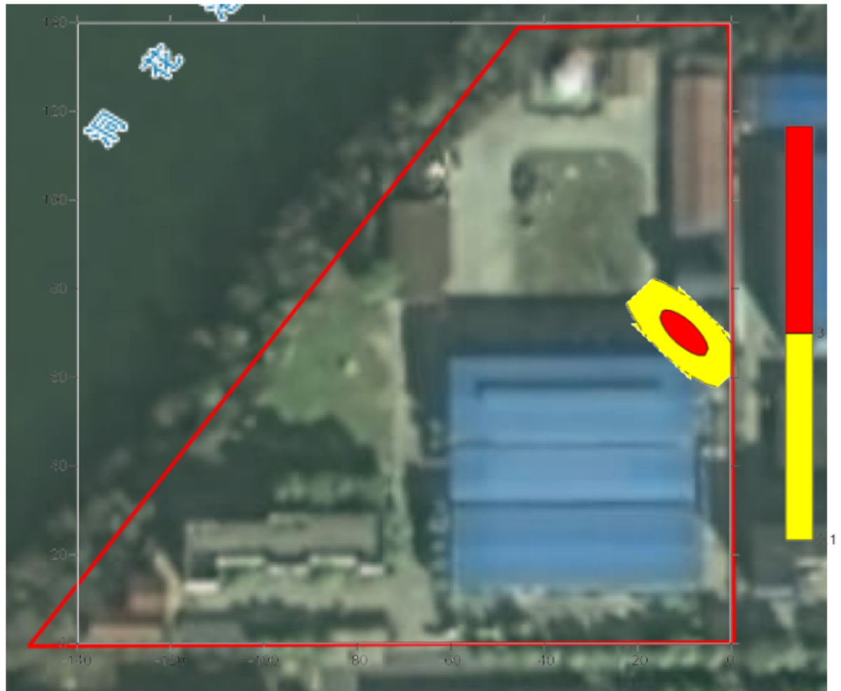
图 4.3-3 废水调节池渗漏发生 1000 天后高锰酸盐的预测结果图
