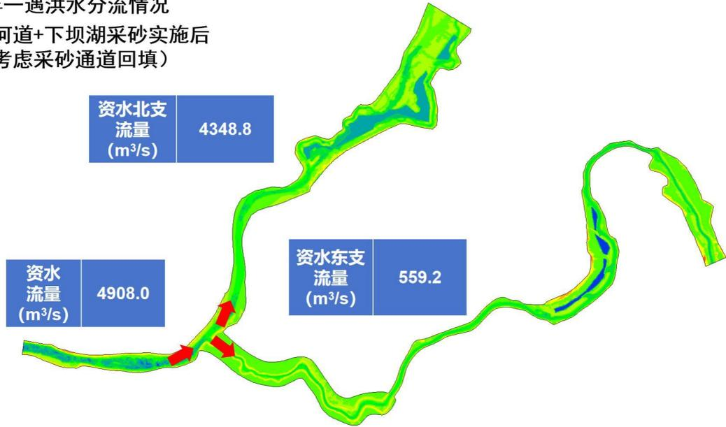
图 4.2-8两年一遇洪水流量下现状河道+下坝湖采砂实施后毛角口分流情况(不考虑采砂通道回填)
