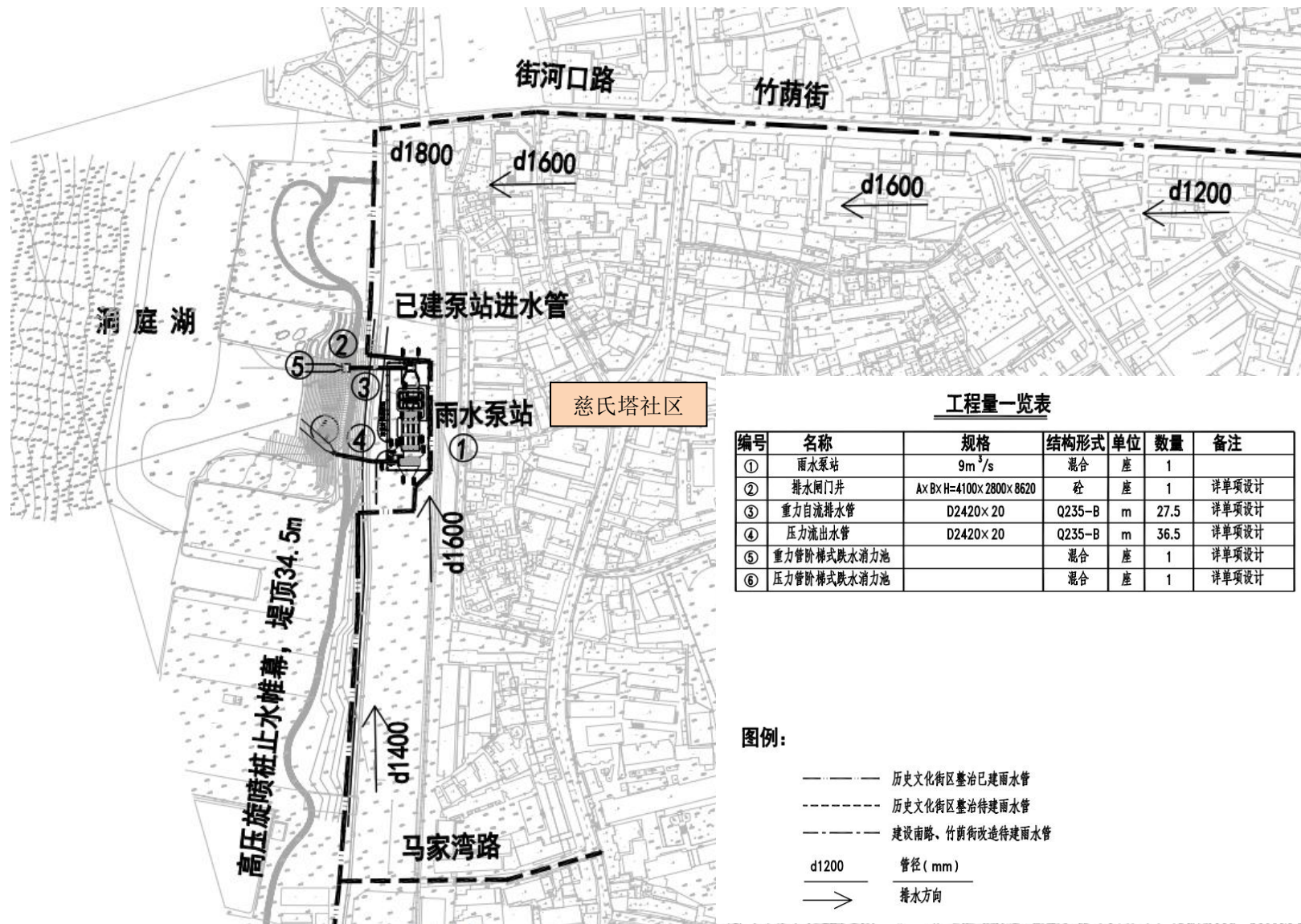
附图 8 街河口雨水泵站 (又称慈氏塔雨水泵站) 平面布置及周边环境示意图
