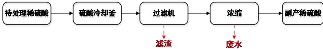
图4.3-5 稀硫酸生产工艺流程图
