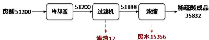
图4.4-5 副产稀硫酸生产物料平衡图（单位：t/a）
