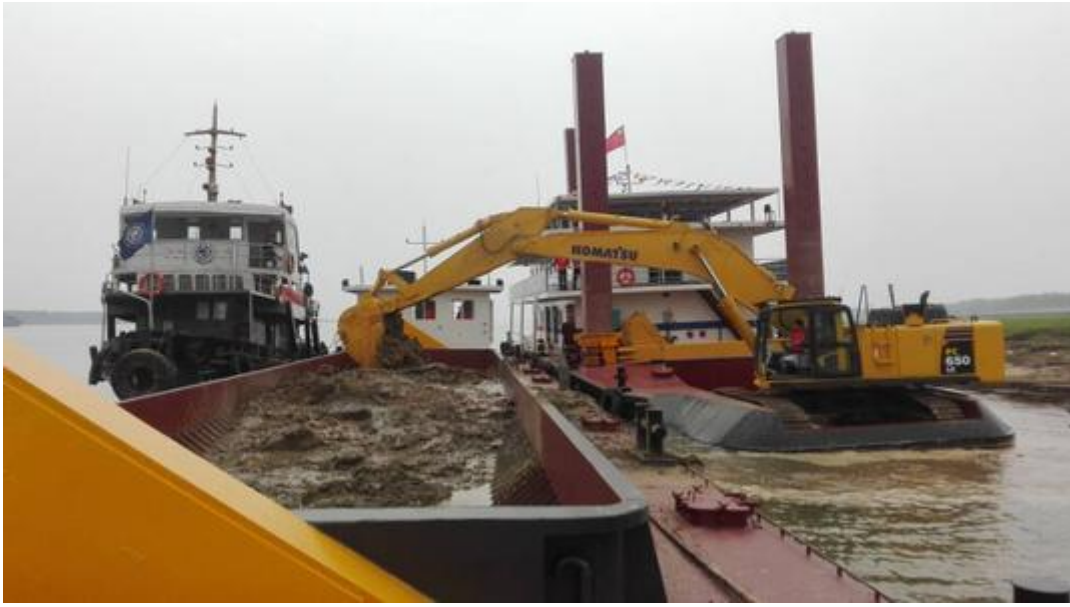
图 3.2-3 铲斗挖泥船疏浚作业示意图
