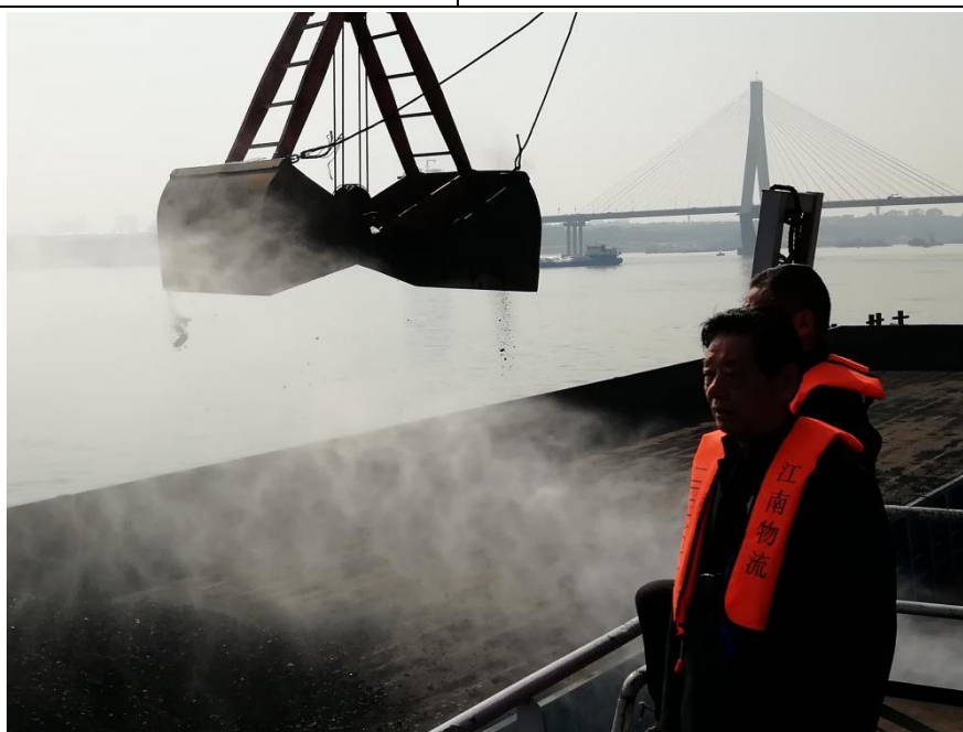
智能雾炮机工作效果示意
