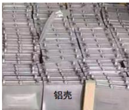
图 2.5-4 废旧磷酸铁锂电池（有电解液）示意图
