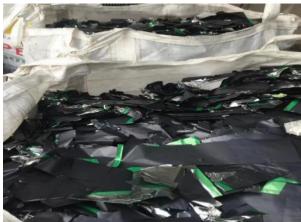
图 2.5-1 磷酸铁锂生产废粉 2.5-2 电池极片及废边角料
