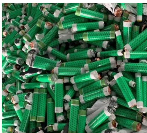
图 2.5-3 磷酸铁锂电池生产废品（无电解液）
