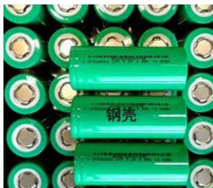
图 2.5-4 废旧磷酸铁锂电池（有电解液）示意图
