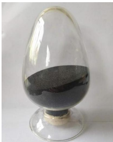
图 2.5-1 磷酸铁锂生产废粉 2.5-2 电池极片及废边角料
