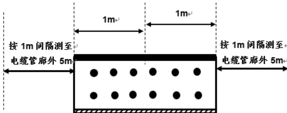
图 7 类比电缆断面监测布点图
