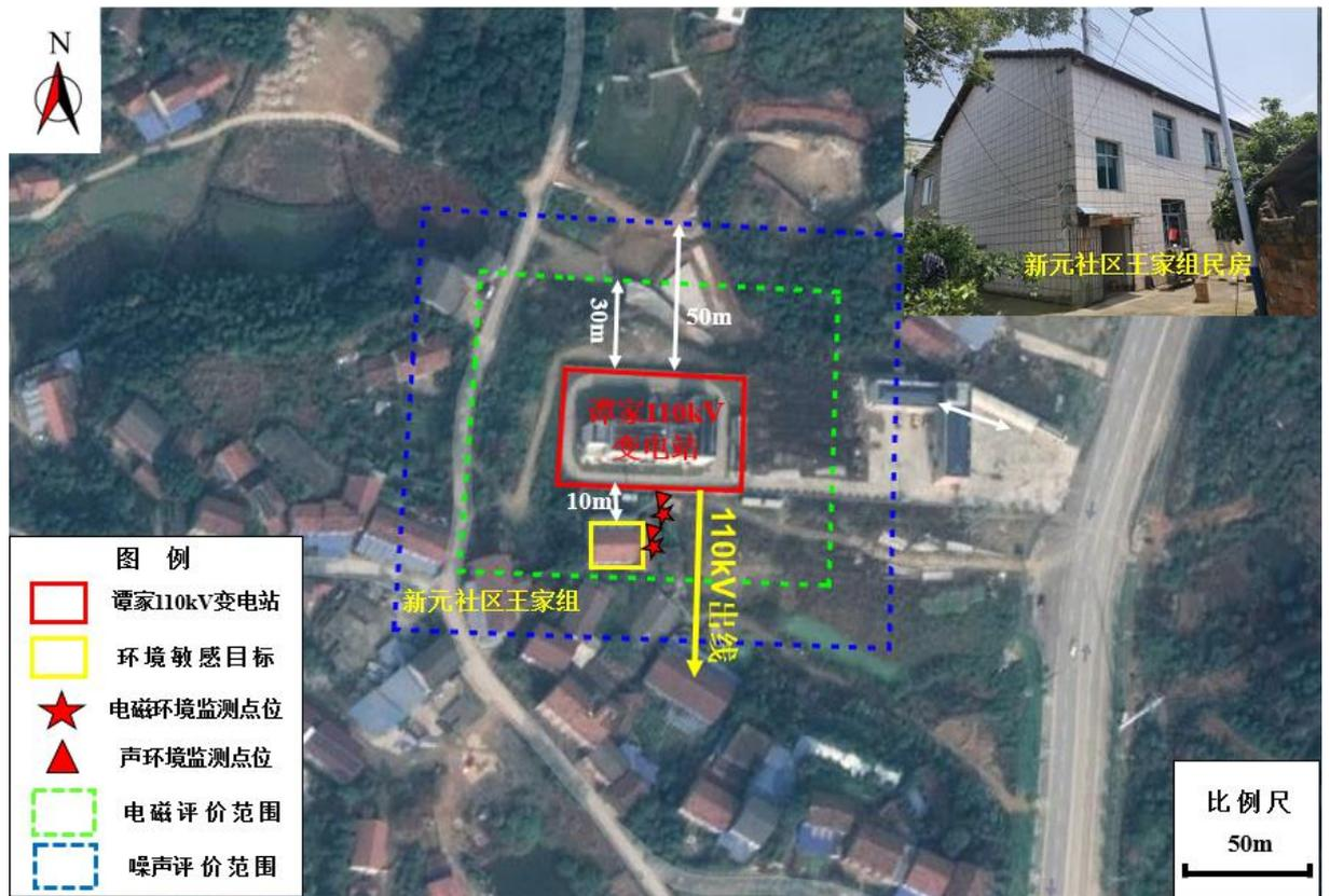
附图 4: 康王 220kV 变电站 110kV 送出工程监测点位示意图
