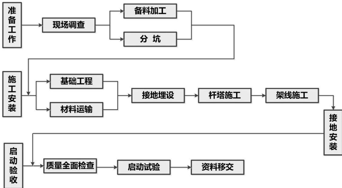
图 1 架空输电线路施工工艺流程
