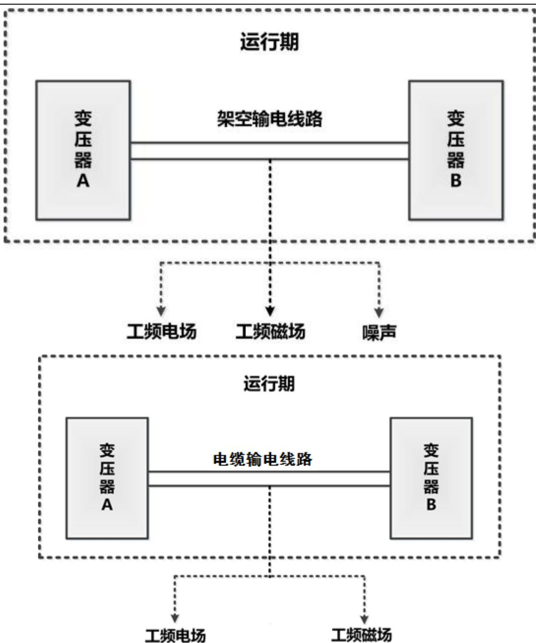
图 6 输电线路运行期的产污节点图
