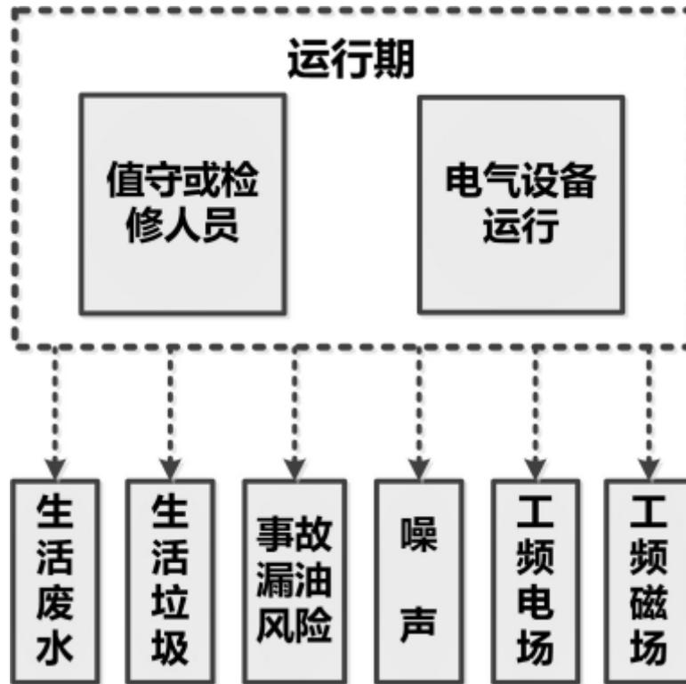
图 5 变电站运行期产污节点图
