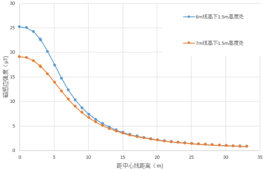
图 15 110kV 单回线路磁感应强度预测结果
