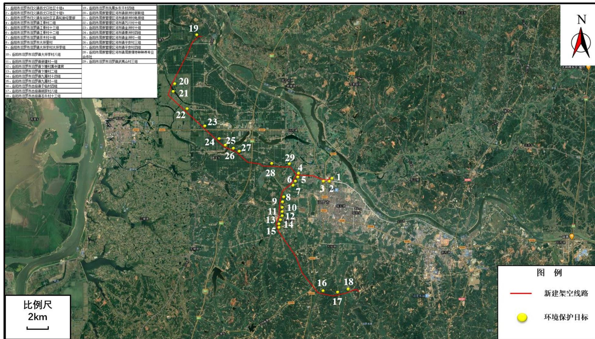
附图 4 百丈 110kV 变电站新建工程环境敏感目标示意图
