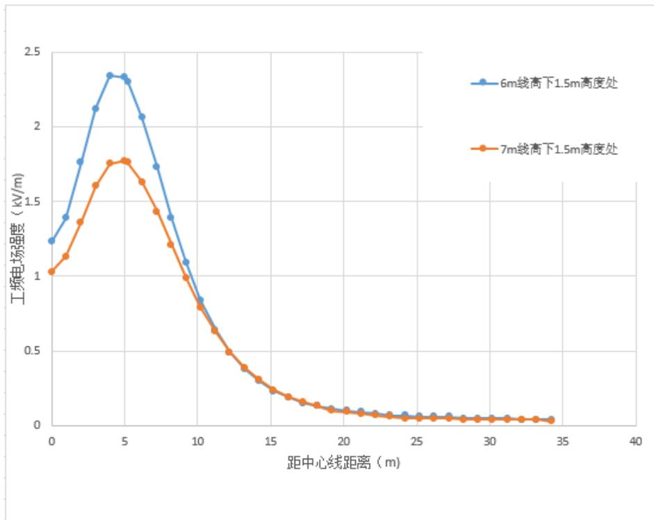
图 19 110kV 双回线路工频电场强度预测结果
