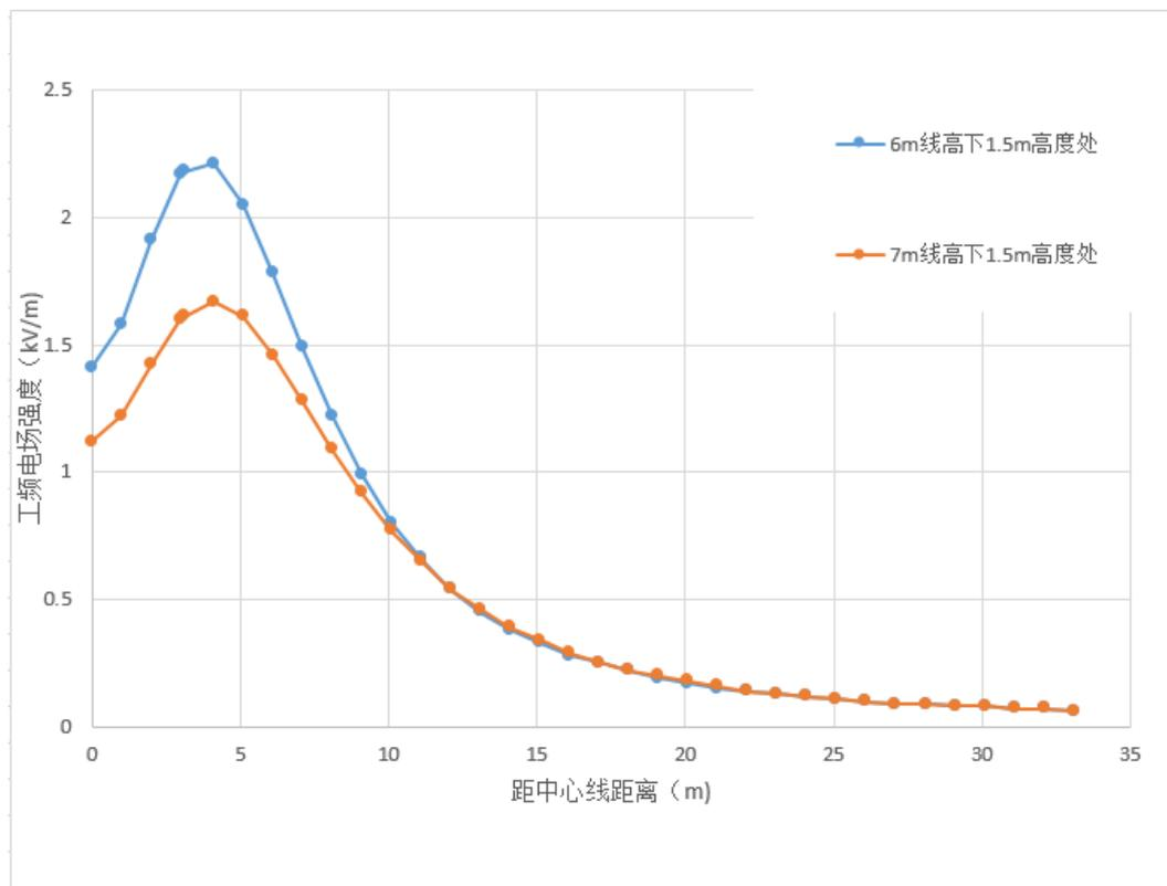
图 14 110kV 单回线路工频电场强度预测结果
