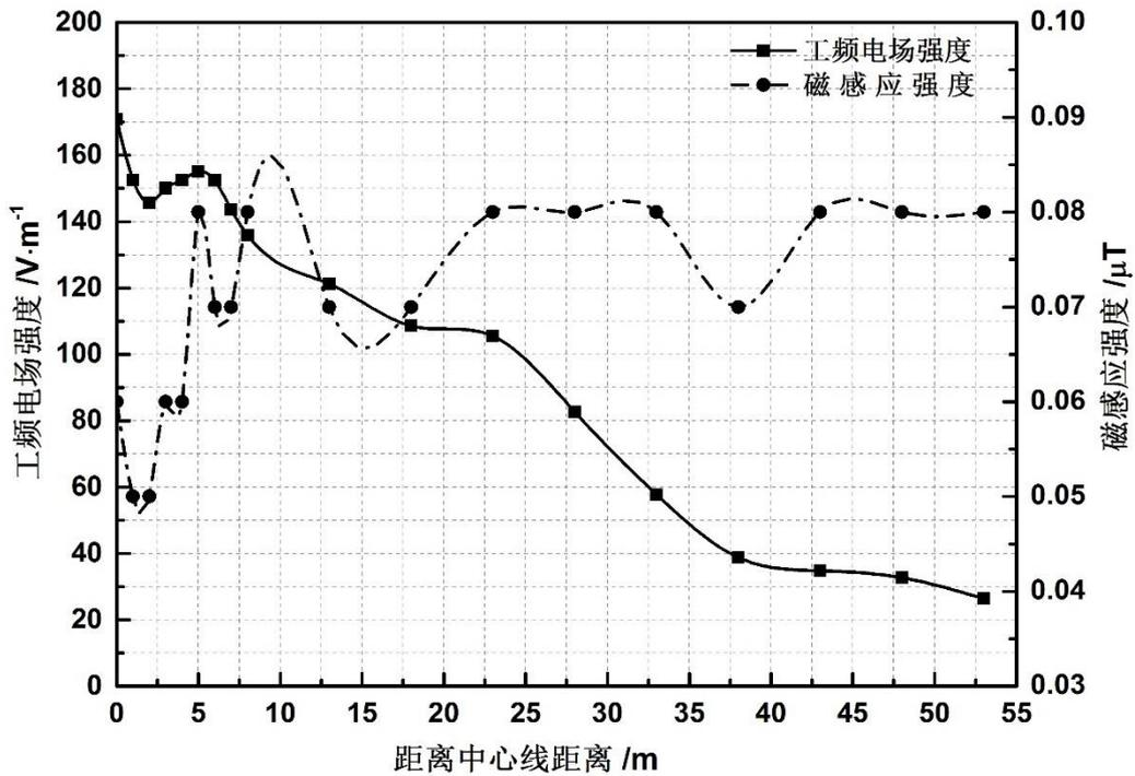
图 11 110kV 桂朴美线工频电场、工频磁场随距离衰减趋势
