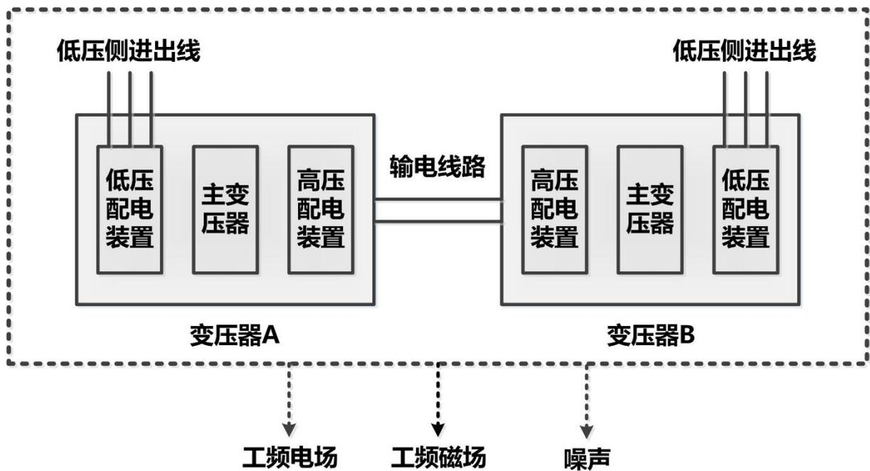
图 2 输变电工程工艺流程图
