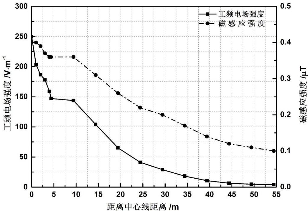
图 12 110kV 图周线、110kV 图湘线工频电场、工频磁场随距离衰减趋势
