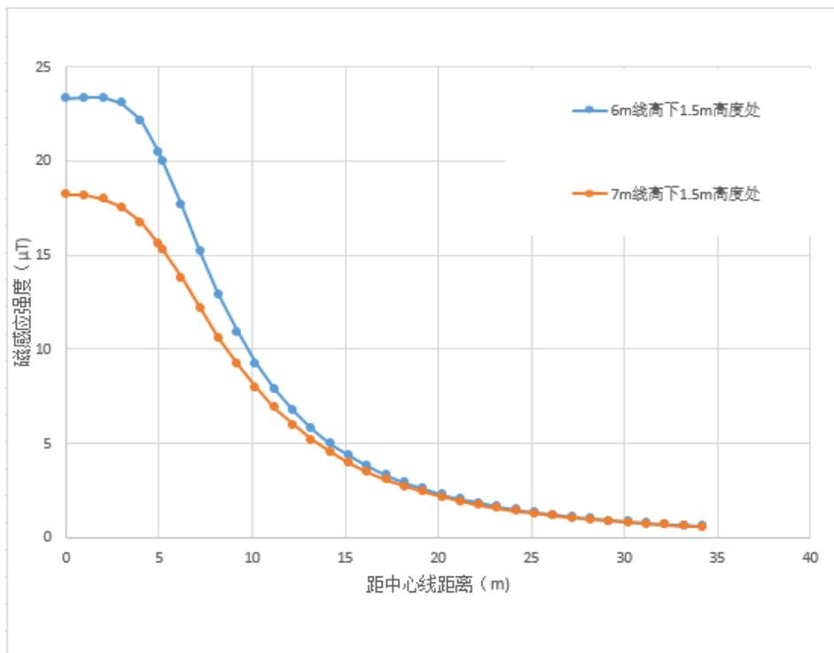
图 20 110kV 双回线路磁感应强度预测结果
