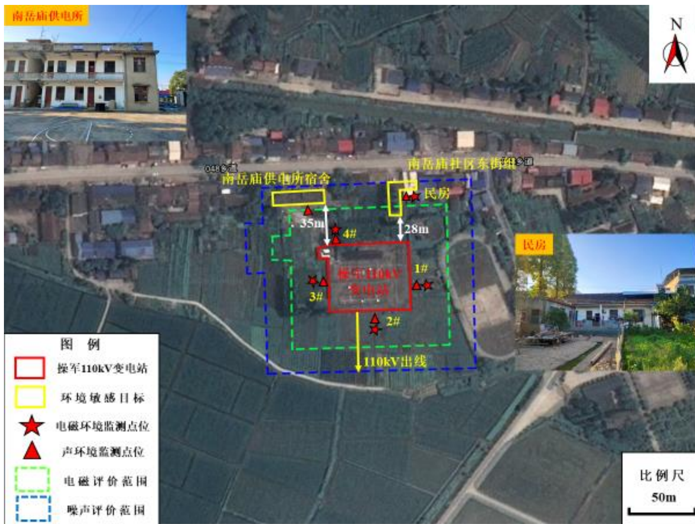
附图三 湖南岳阳华容操军 110kV 变电 1 号主变扩建工程环境敏感目标示意图
