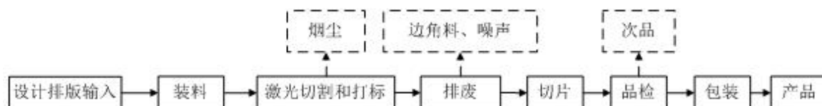
图 5-2 激光生产工艺流程图
