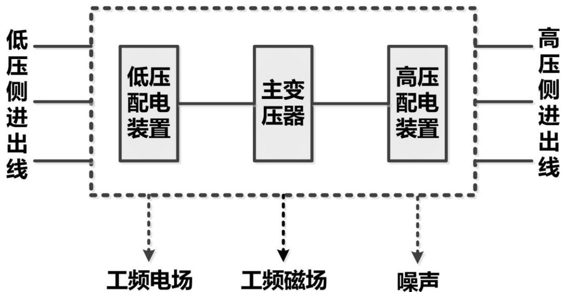
图 2 变电工程工艺流程图
