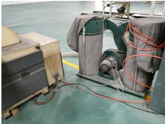
图 7 北京创然铝塑工业有限公司铝塑板生产线切割粉尘收集器图
