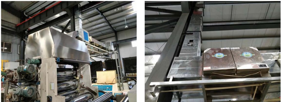
图 6 北京创然铝塑工业有限公司铝塑板生产线有机废气治理装置图
