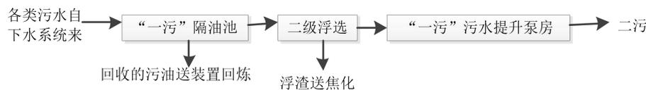
图 10.1-2 长岭分公司第一污水处理厂含油（含盐）污水处理工艺简要流程
